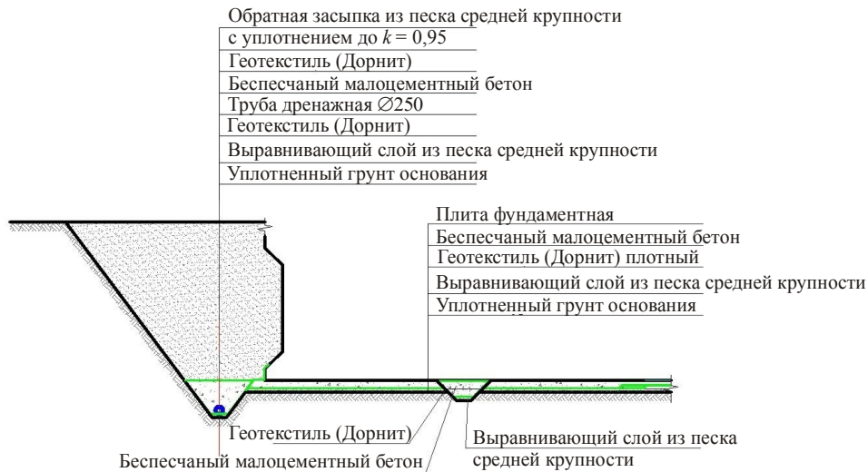
Рис. 6. Схема конструкции дренажа на эксплуатационный период
